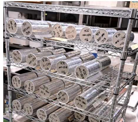
図-3.4 スラブ模擬養生
