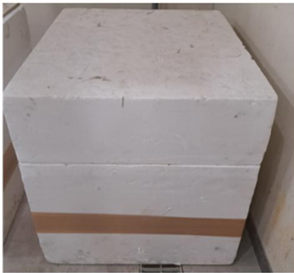
図-3.3 簡易断熱養生箱
